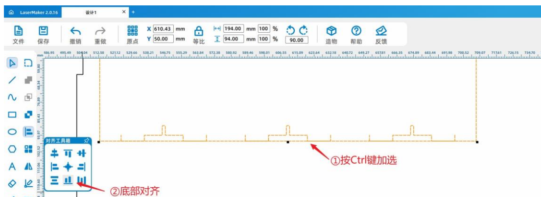
图 14 将公卡口与加装板底部对齐
